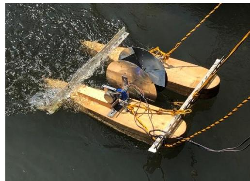
図1. 浮体式小水力発電装置
