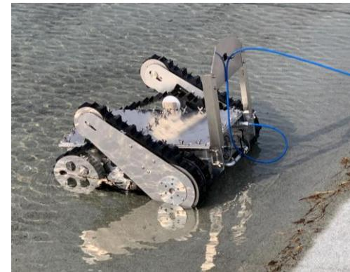
図1 小型水中クローラ型作業ロボットの試作機（福島ロボットテストフィールドでの実験の様子）
