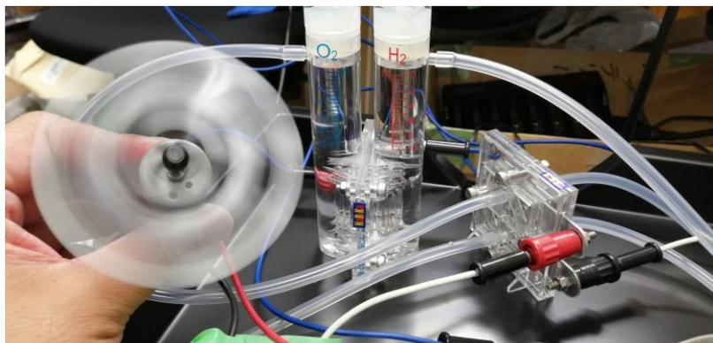
▲燃料電池による電気の発電実験の様子
