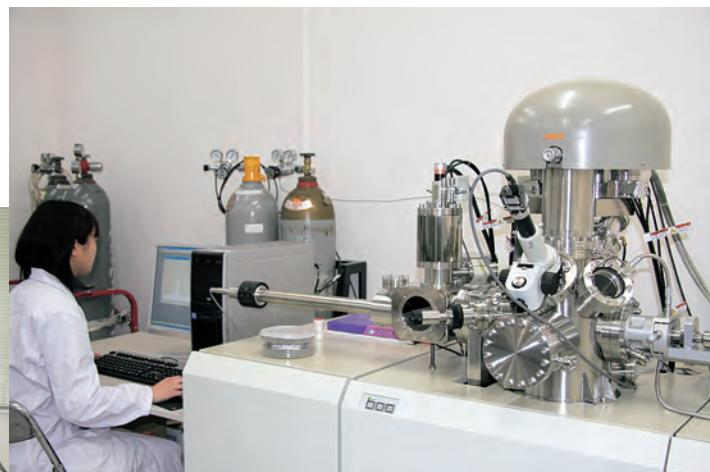
X線光分子分光分析装置 X-ray Photoelectron Spectrometer
