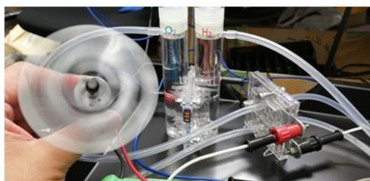
▲燃料電池による電気の発電実験の様子
