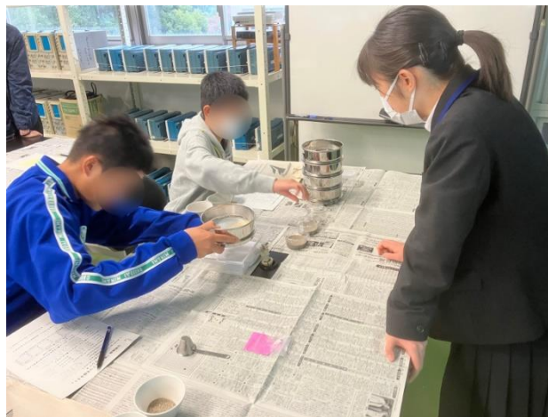
砂のふるい分けの実験のようす
