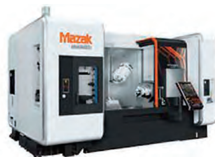
複合加工機 (INTEGREX i-200 ヤマザキマザック株式会社) Compound machining machine
