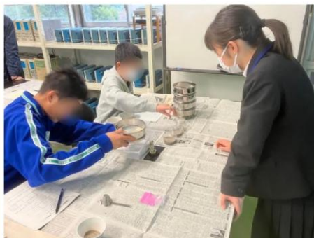
砂のふるい分けの実験のようす
