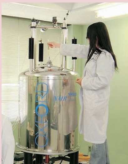
フーリエ変換核磁気共鳴装置 FT NMR Spectrometer
