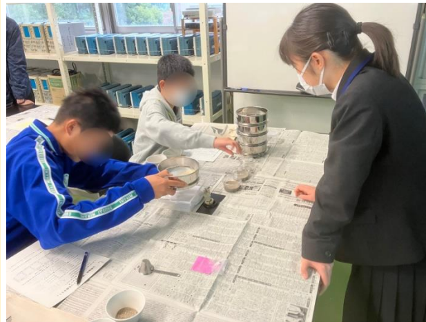
砂のふるい分けの実験のようす
